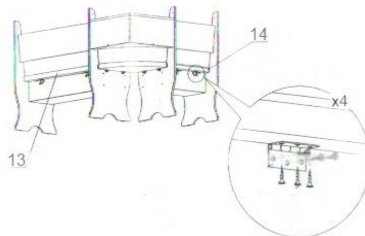
Установите угловое сидение на уголки металлические, закрепите при помощи шурупов 4x16.
