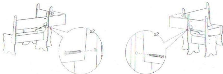
Далее произведите установку мягких сидений. Для этого по наметкам на царгах ящика №7, №9 и сидений с мягким элементом №13 и №14 установите петлю форточную при помощи шурупов 4x16.
