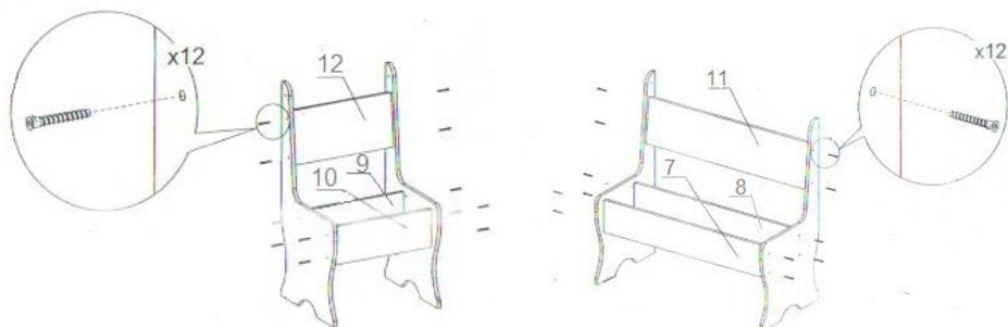
Перевернув изделие закрепите дно скамьи при помощи гвоздей. В нижнюю часть боковых стенок №1, 2, 3 вбейте при помощи молотка опоры мебельные с гвоздем.
