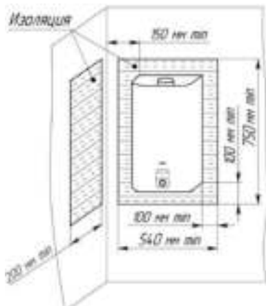
Рисунок 4. Установка аппарата на трудносгораемых стенах
