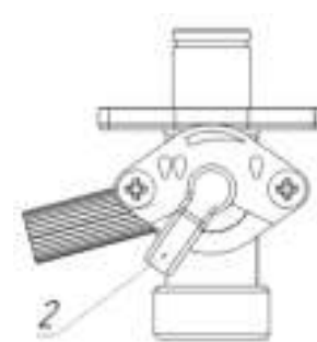
в) Ручка регулировки расхода воды 2 в положении «Максимальный расход»
