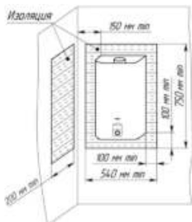
Рисунок 4. Установка аппарата на трудносгораемых стенах
