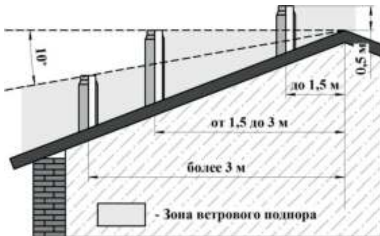
Рисунок 6 - Требования к высоте дымохода
