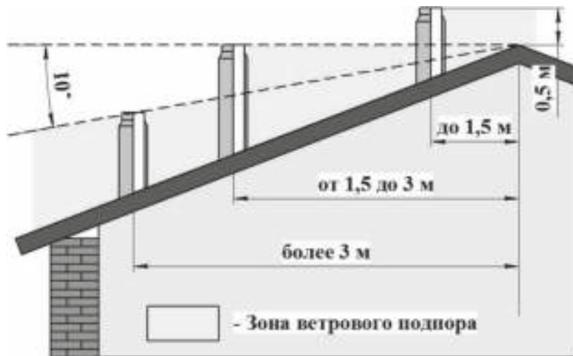
Рисунок 2 — Требования к высоте дымохода котла
