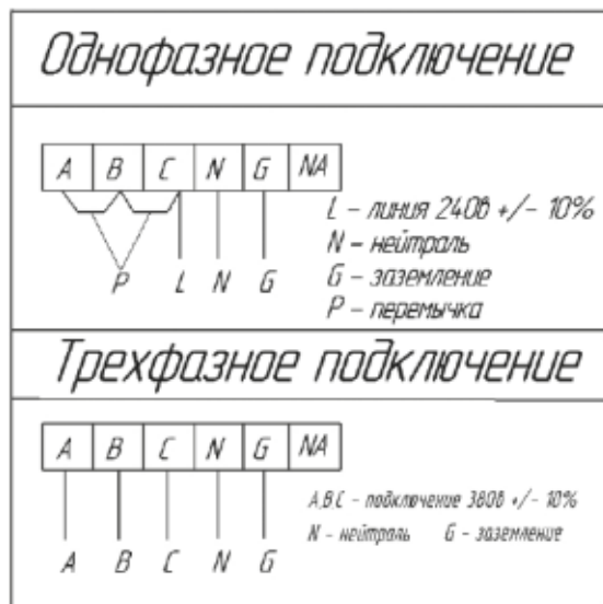
Рис. 4. Схемы подключения электрического котла к электросети.
