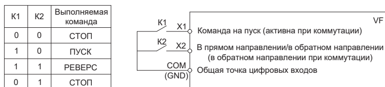
Рисунок 10.9-6. Двухпроводная схема управления 2
