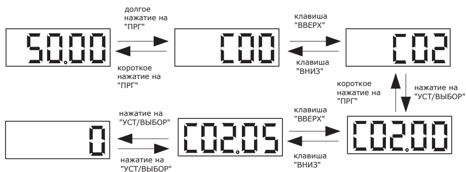
Рисунок 5.5-3. Основные операции на панели управления
