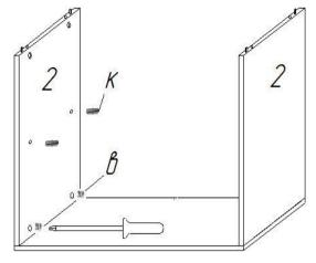
Необходимо закрепить детали при помощи эксцентриковой стяжки
