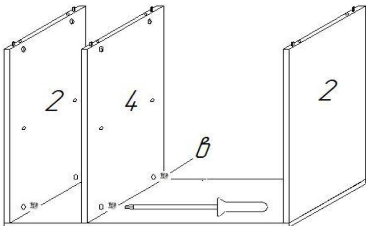
Необходимо закрепить детали при помощи эксцентриковой стяжки
