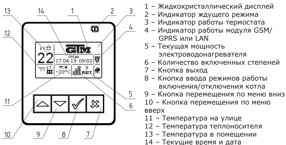
Рис. 2 Расположение органов управления и индикации на передней панели
