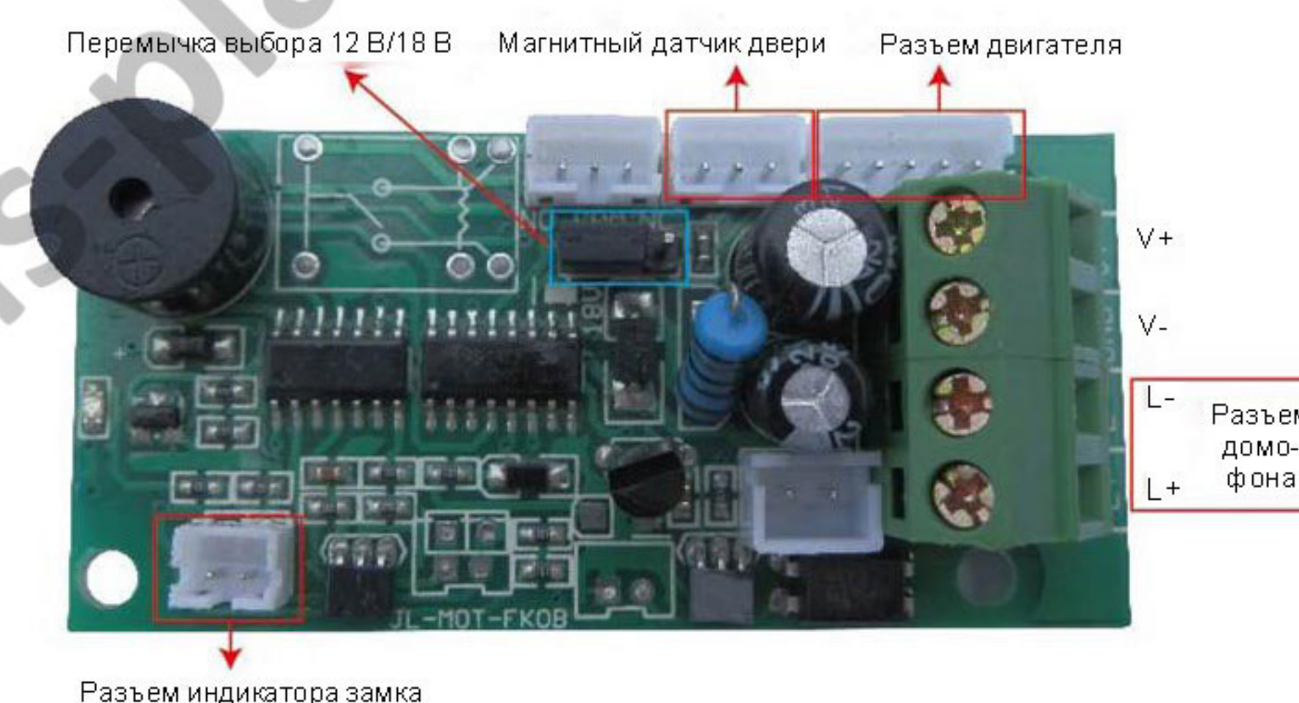
Схема подключения разблокировки с положительным потенциалом
