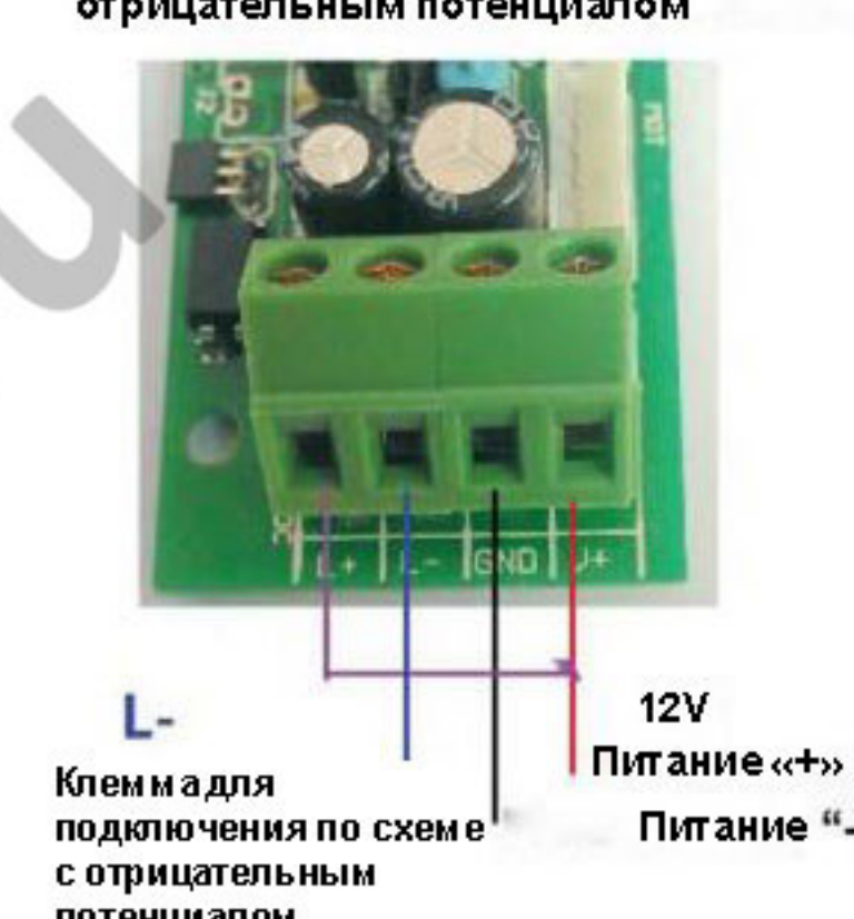
Схема подключения разблокировки с отрицательным потенциалом
