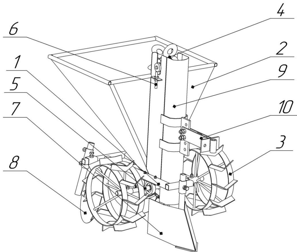
1 – рама; 2 – бункер; 3 – колесо приводное; 4 – транспортёр ложечный; 5 – привод; 6 – натяжитель; 7 – сошник; 8 – окучник; 9 – желоб направляющий; 10 – сцепка;
