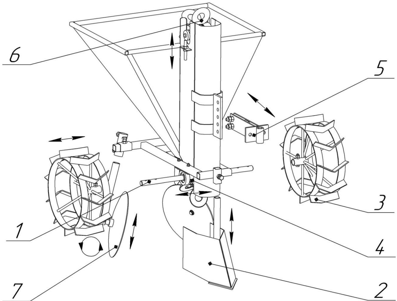
1 – приводной вал; 2 – сошник; 3 – колесо приводное;
