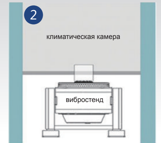
соединить вибростенд с камерой через переходника
