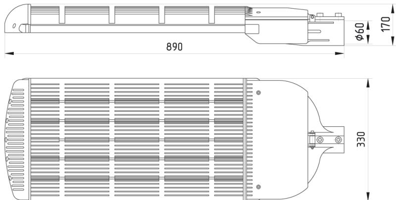
Уличный светодиодный светильник для освещения автомагистралей, многополосных дорог категорий А и В, а также площадей. Может применяться для освещения железнодорожных платформ и переездов. Светильник ДКУ 01-60x4-002 предназначен для замены уличных светильников ЖКУ-400 (лампа ДНаТ-400) и РКУ-700 (лампа ДРЛ-700). Светильник комплектуется высокоэффективной вторичной оптикой Ledil (Финляндия) с полуширокой диаграммой, что позволяет добиться необходимой равномерности освещения проезжей части.
