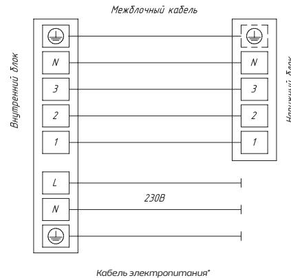
\* Кабель электропитания подключен к плате управления внутреннего блока блока
