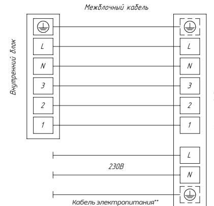
\*\* Кабель электропитания подключен к плате управления наружного блока блока
