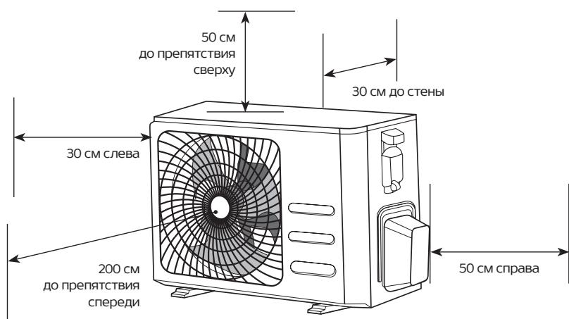
В случае, если в месте установки возможны сильные порывы ветра (например, на побережье), убедитесь, что вентилятор вращается без затруднений, и блок расположен вдоль стены, или используйте заграждение от ветра (см. рисунок). По возможности устанавливайте наружный блок с подветренной стороны.
