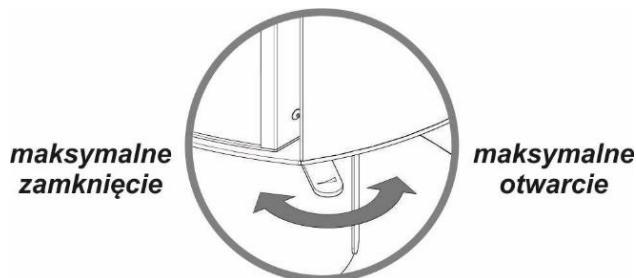
Rysunek 13. Ustawienie przycisku regulacji dopływu powietrza w pozycji maksymalnego otwarcia dla ogrzewacza CERES TOP
