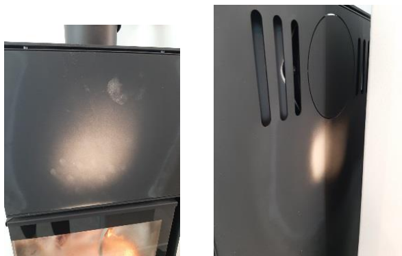
Rysunek 11. Przykłady przebarwień powstałych w wyniku przegrzewania urządzenia.
