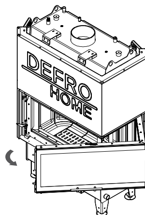
Rysunek 23. Umieszczenie rygli pozwalających na otwarcie drzwi gilotynowych w pozycji rozwieralnej wkładu kominkowego DEFRO HOME RIVA BP i BL w wersji G oraz widok drzwi w pozycji rozwieralnej.
