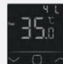
При выборе датчика воздуха и датчика пола, необходимо установить максимально допустимую температуру пола.
