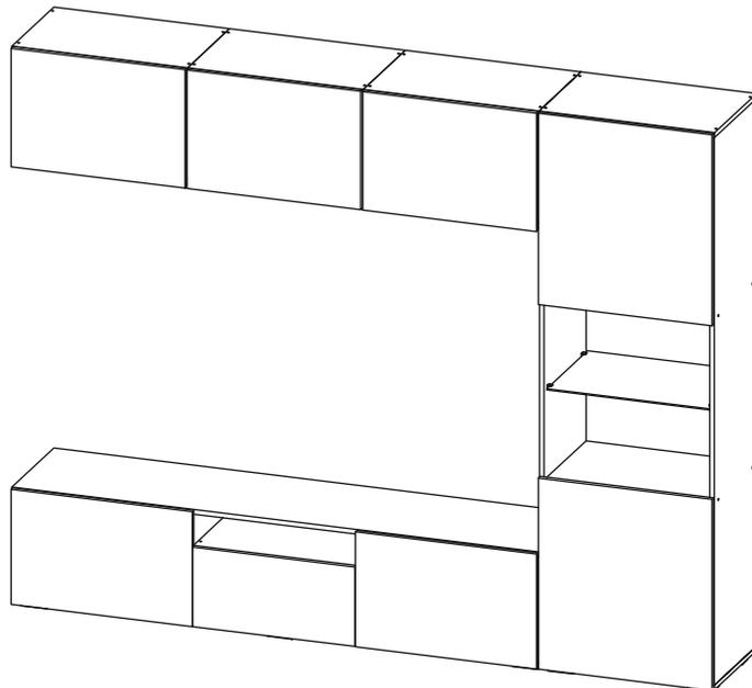
Универсальная сборка. Нагрузка на стеклополку не более 5 кг. при равномерно распределённой нагрузке.
