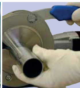
Система быстрой смены инструментов, зажимных колец и труб
