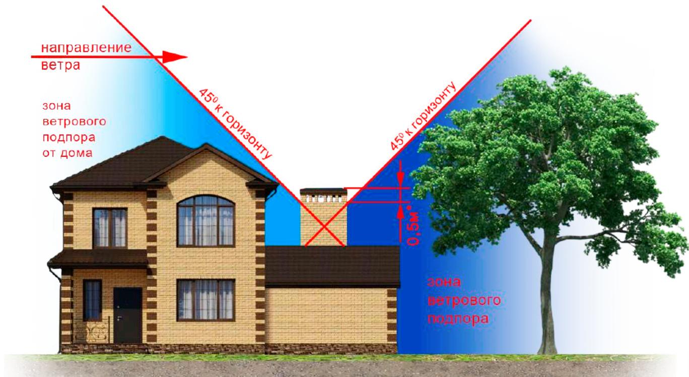
**2.3.3** Зона ветрового подпора определяется плоскостью, проходящей под углом 45 градусов к горизонту через наиболее высокую линию соседнего здания или другого сооружения, деревьев.
