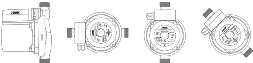
При правильной установке циркуляционного насоса, ось ротора должна быть параллельна земле. Не допускается установка насоса в положении, когда клеммная коробка расположена под корпусом электродвигателя.
