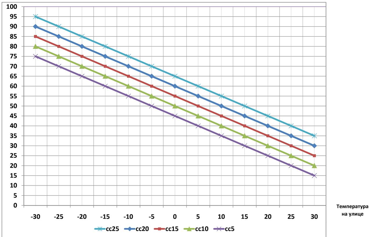
Параметр (CC) меняет кривую системы отопления. Для того чтобы настроить погодозависимое управление системой отопления необходимо подключить датчик уличной температуры. При этом котёл сам перейдёт на погодозависимое управление. Для настройки нужно только выбрать желаемую кривую системы отопления на основании графика, путём изменения параметра (CC) в меню установки системных параметров котла.
