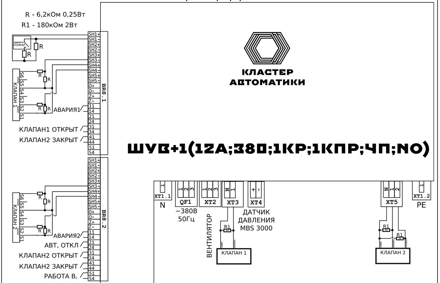
Рис. 6: Схема внешних подключений для управления одним вентилятором 380В с ЧП, и двумя приводами клапанов (с пружиной, и реверсивным)
