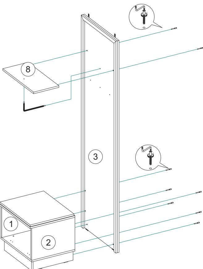
**4.** Соедините евровинтами боковины тумбы №1, №2 с задней стенкой №3, а также полку №8 с задней стенкой №3.
