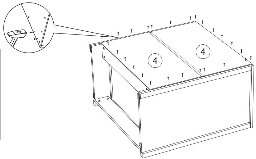
**8.** Соедините заднюю стенку ящика №7 с боковинами ящика №6 евровинтами, предварительно вставив дно ящика №8 в соответствующие пазы.
