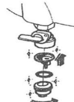
**Снятие фильтрующего элемента**
