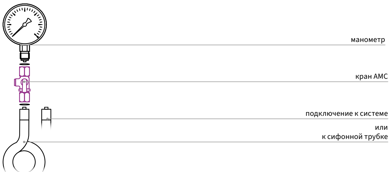
1. Измерение напора циркуляционного насоса (разница давления между всасывающим и напорным патрубками).
