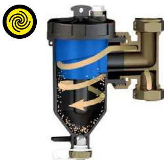
Шаг 1: Введение теплоносителя в вихревое движение.
