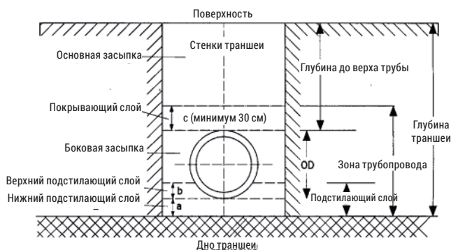
РИС. 3. УСТРОЙСТВО ТРАНШЕИ
