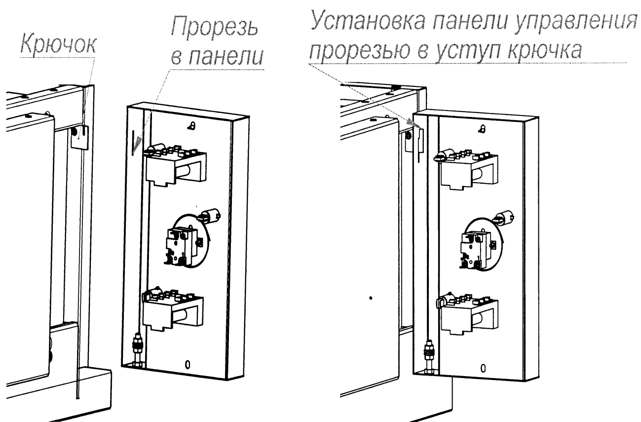
Рис. 5. Технологическое окно для замены контрпетли.
