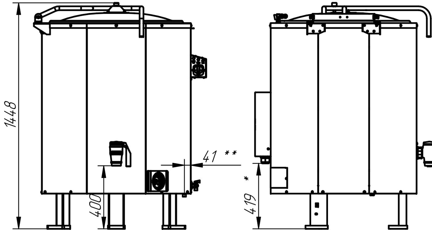
Котлы пищеварочные электрические типа КПЭМ предназначены для приготовления бульонов, третьих блюд и кипячения воды. Имеет три режима работы. Слив готового продукта осуществляется краном 2" на передней панели. Удобная ручка крышки фиксируется в любом положении. Нагрев воды осуществляется способом "пароводяной рубашки". При отсутствии воды в "пароводяной рубашке" срабатывает автоматическое отключение котлов. Котел поставляется с монтажными лапами, крепящимися к полу фундаментными болтами М10х100.
