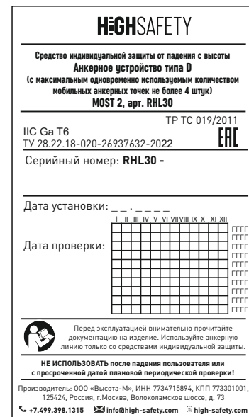
Рис. 3 Маркировка информационной таблички анкерной линии MOST 2.
