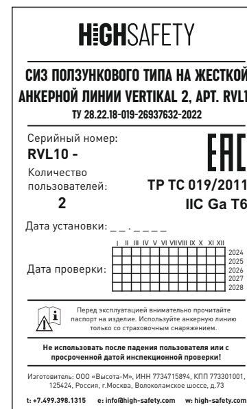
Рис. 3 Маркировка информационной таблички анкерной линии VERTIKAL 2.
