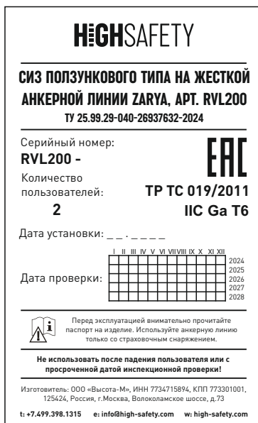
Рис. 3 Маркировка информационной таблички анкерной линии ZARYA.
