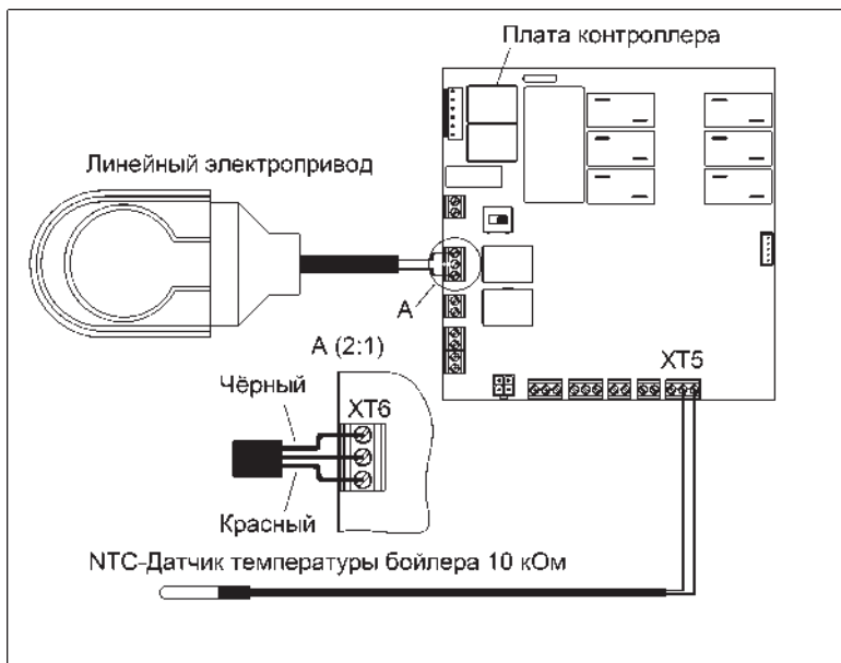
Рисунок 30. Схема подключения 3-ходового клапана ГВС совместно с NTC-датчиком
