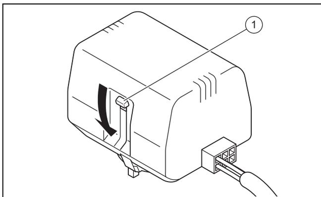
3. Чтобы установить переключающий вентиль отопление/нагрев накопителя в среднее положение, нажимайте на белый переключающий рычаг (1), на крышке двигателя переключающего вентиля, пока он не зафиксируется в своем среднем положении.
