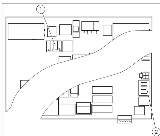
Для подключения разделительного реле внешнего скважинного насоса имеется разъем для переключающего контакта X143 (1), с клеммами Lb, La, N, PE.
