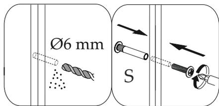
При наличии рядом стоящего модуля рекомендуем выровнять и скрепить их между собой межсекционной стяжкой, это придаст дополнительную жесткость всей конструкции.
