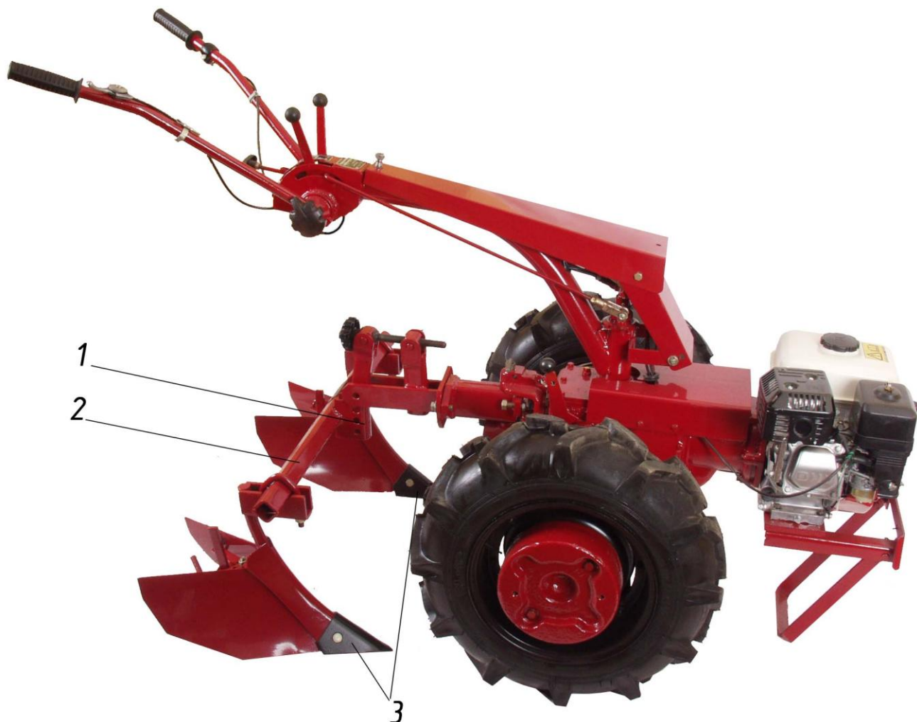
Рисунок 16 – Мотоблок в агрегате с окучником 1 – стойка; 2 – труба; 3 – носок окучника
