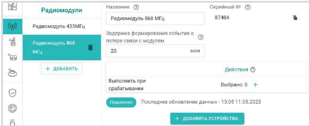
Обмен данными по радиоканалу 868 МГц осуществляется по оригинальному шифрованному протоколу, который поддерживает только оригинальные датчики ZONT:
