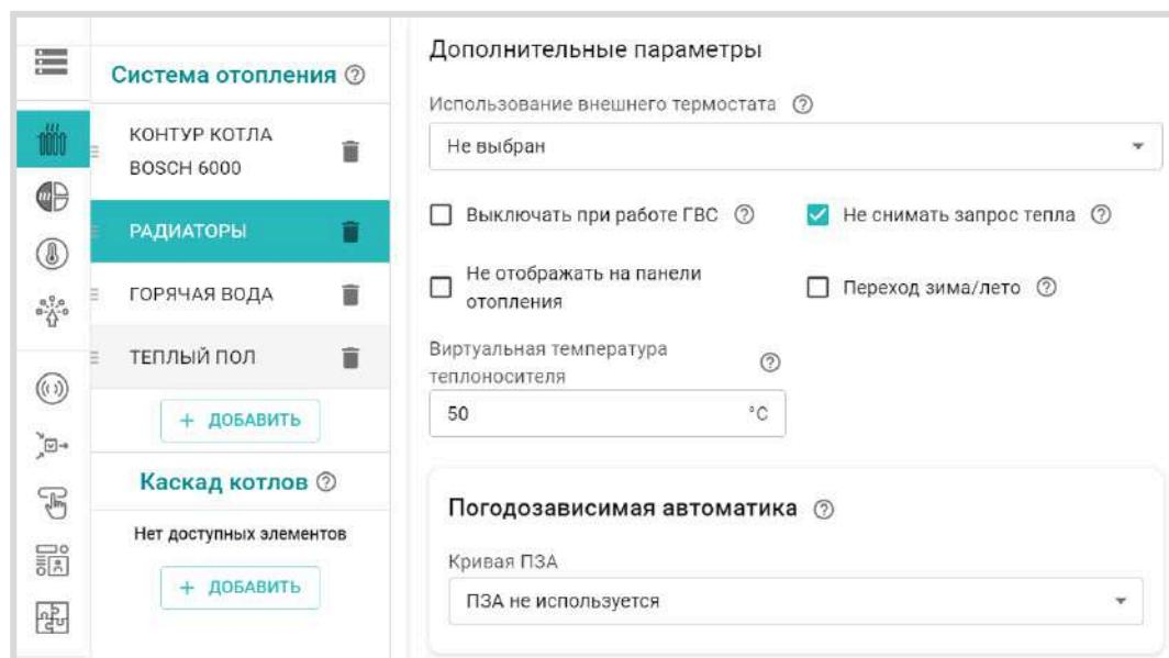
**Использование внешнего термостата** – параметр для настройки контура со сторонним устройством управления с дискретным выходным сигналом. На панели такого контура отображается символ термостата
