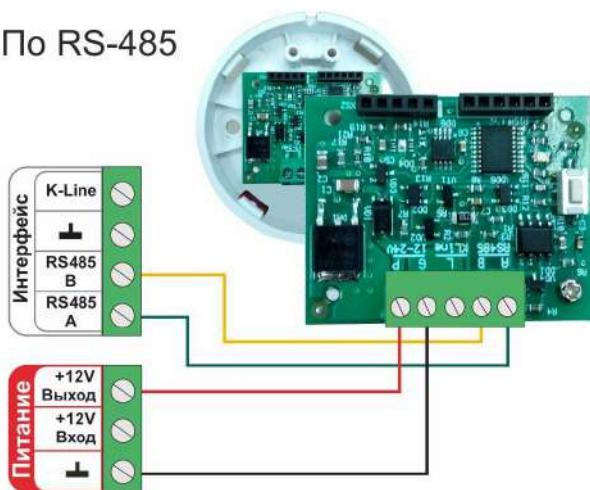
Допускается подключение только оригинальных датчиков температуры ZONT МЛ-778 и датчиков температуры / влажности МЛ-779.
