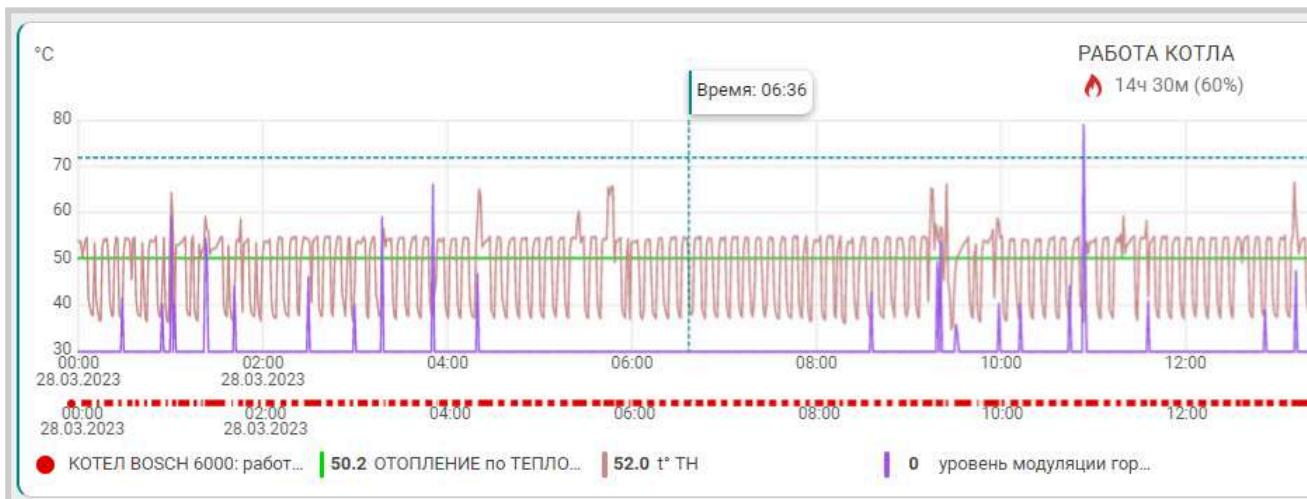
**Примечание:** При наведении курсора на название параметра в легенде, выделяется график только этого параметра, а остальные отображаются фоном. Двойной клик на параметре меняет единицы измерения шкалы Y на единицы соответствующие этому параметру. Например, если на графике изображены влажность и температура и шкала Y была проградуирована в градусах, то при двойном клике по названию параметра единицы измерения шкалы Y поменяются с градусов на проценты.
