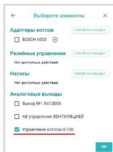
В результате такой настройки “запрос на тепло” к котловому контуру из расчетной температуры теплоносителя будет преобразован в управляющее напряжение и через аналоговый выход поступит на аналоговый вход 0-10 В котла.
