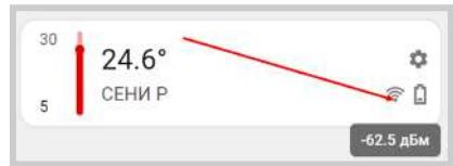
**ВНИМАНИЕ!!!** Если мощность радиосигнала датчика менее -90дБм, то обмен данными с ним не стабильный, и Контроллер будет периодически информировать о потере связи с радиоустройством. В этом случае необходимо найти другое место для размещения радиодатчика и/или радиомодуля.
