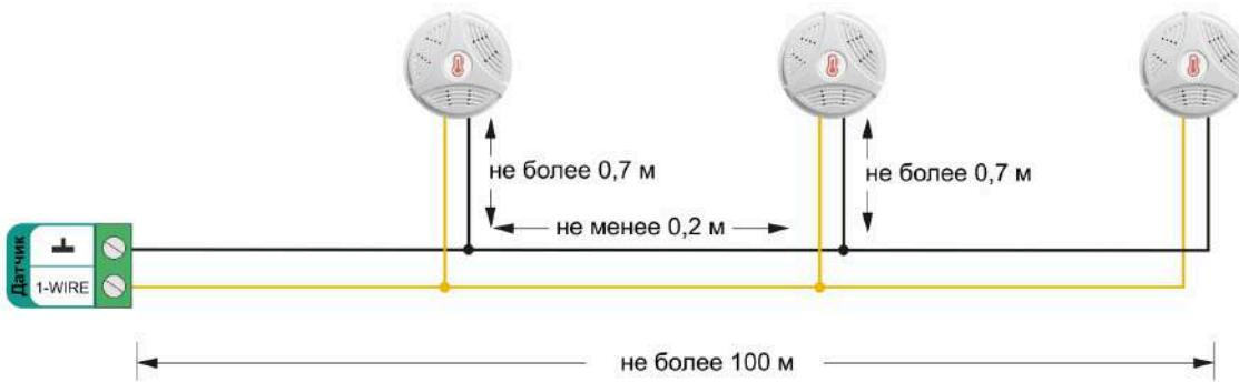
Подключение датчиков по трехпроводной схеме:
