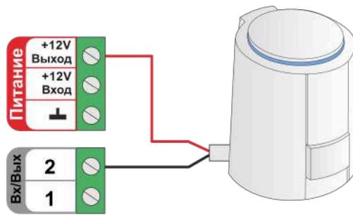
Схема подключения к релейному выходу:
