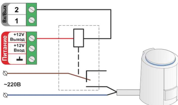
В качестве дополнительного промежуточного реле рекомендуется использовать **реле 12V DC артикул ML00000291**. Ссылка на карточку товара ресурс [https://zont.online/ Реле промежуточное на DIN-рейку, 12V DC в сборе](https://zont.online/).
