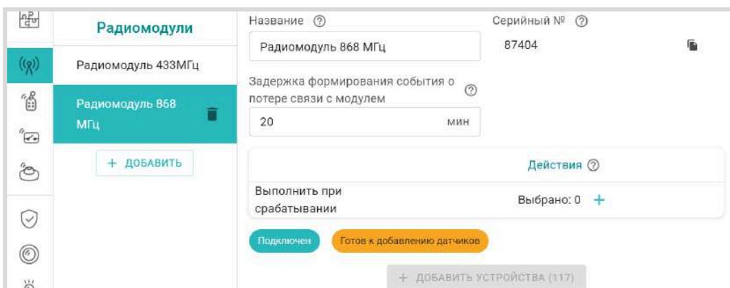
**Для регистрации датчиков 868 МГц** в период действия режима добавления радиоустройств нужно нажать и удерживать кнопку на плате датчика до того момента пока светодиодный индикатор на нем не загорится на 1-1,5 секунды.
