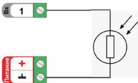
Диапазон измерения сопротивления датчиков: 10 кОм – 200 кОм.
