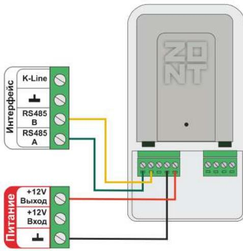
Схема подключения внешнего адаптера цифровой шины **DIN** по **RS-485**:
