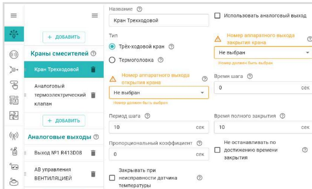
Для обеспечения плавного регулирования температуры теплоносителя в контуре необходимо импульсное управление вращением привода в сторону “открывания” и “закрывания”. При подаче
