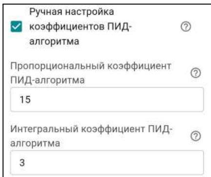
Настройка регулятора производится с целью подобрать коэффициенты для того, чтобы он поддерживал целевую температуру воздуха, не допуская значительных колебаний. Увеличение коэффициентов тормозит алгоритм, уменьшение ускоряет.
