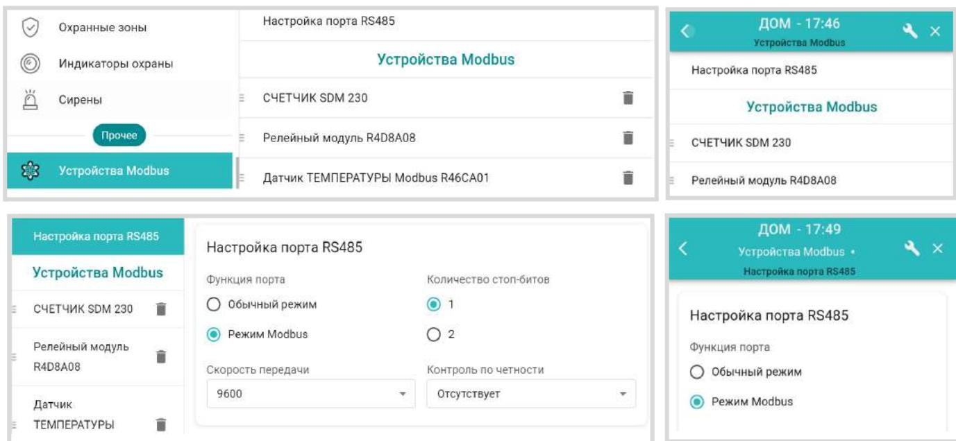
**ВНИМАНИЕ!!!** В Контроллере аппаратно реализованы 2 порта RS-485. Для подключения Modbus устройств предназначен только один, расположенный в нижней части клеммной колодки прибора. Использование второго порта (верхняя часть контроллера) для этой задачи не предусмотрено.
