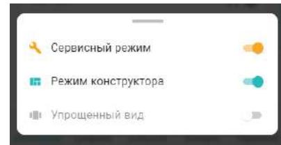
**Режим конструктора** разрешает менять отображаемые окна и параметры вкладок контроля и управления:
