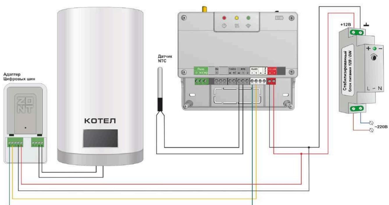
При таком подключении Термостат считывает из цифровой шины котла фактическую температуру теплоносителя и другие параметры его работы, сравнивает целевую и текущую температуры воздуха в помещении или теплоносителя в системе отопления и рассчитывает температуру теплоносителя, оптимальную для поддержания целевой температуры действующего режима отопления.
