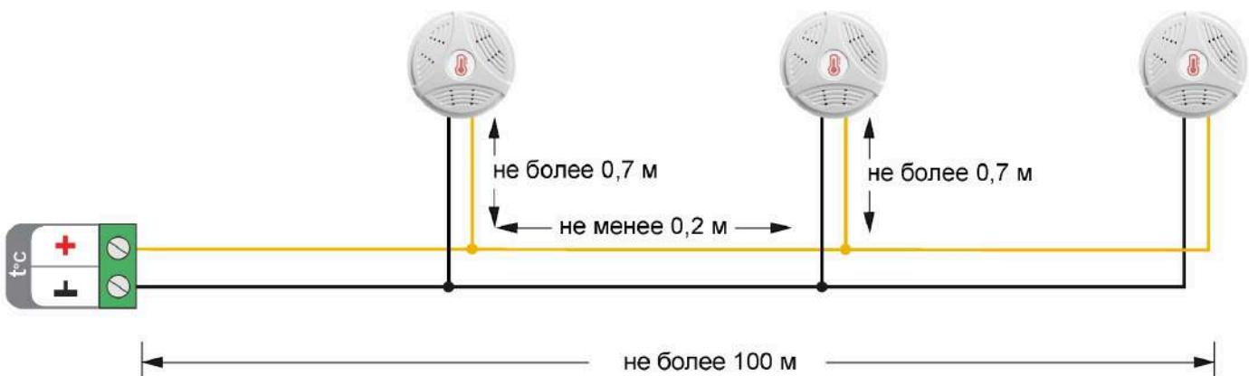
Подключение датчиков по трехпроводной схеме:
