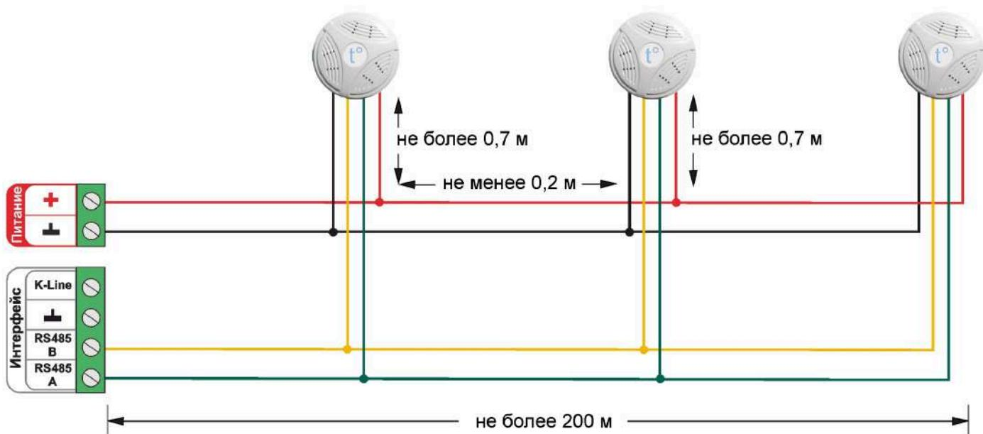
Подключение нескольких датчиков по K-Line:
