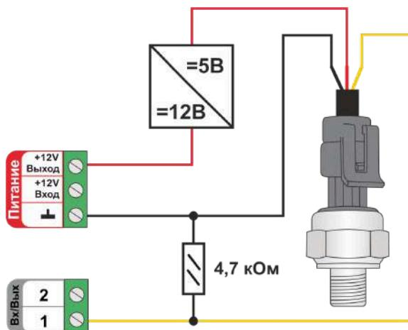
**Примечание:** Резистор подтяжки номиналом 4,7 кОм устанавливается только если входу Термостата, к которому подключен датчик давления, настройкой назначен оригинальный тип сенсора. В этом случае при "обрыве датчика" формируется соответствующее событие. Если тип сенсора назначен "аналоговый вход" – резистор не нужен.
