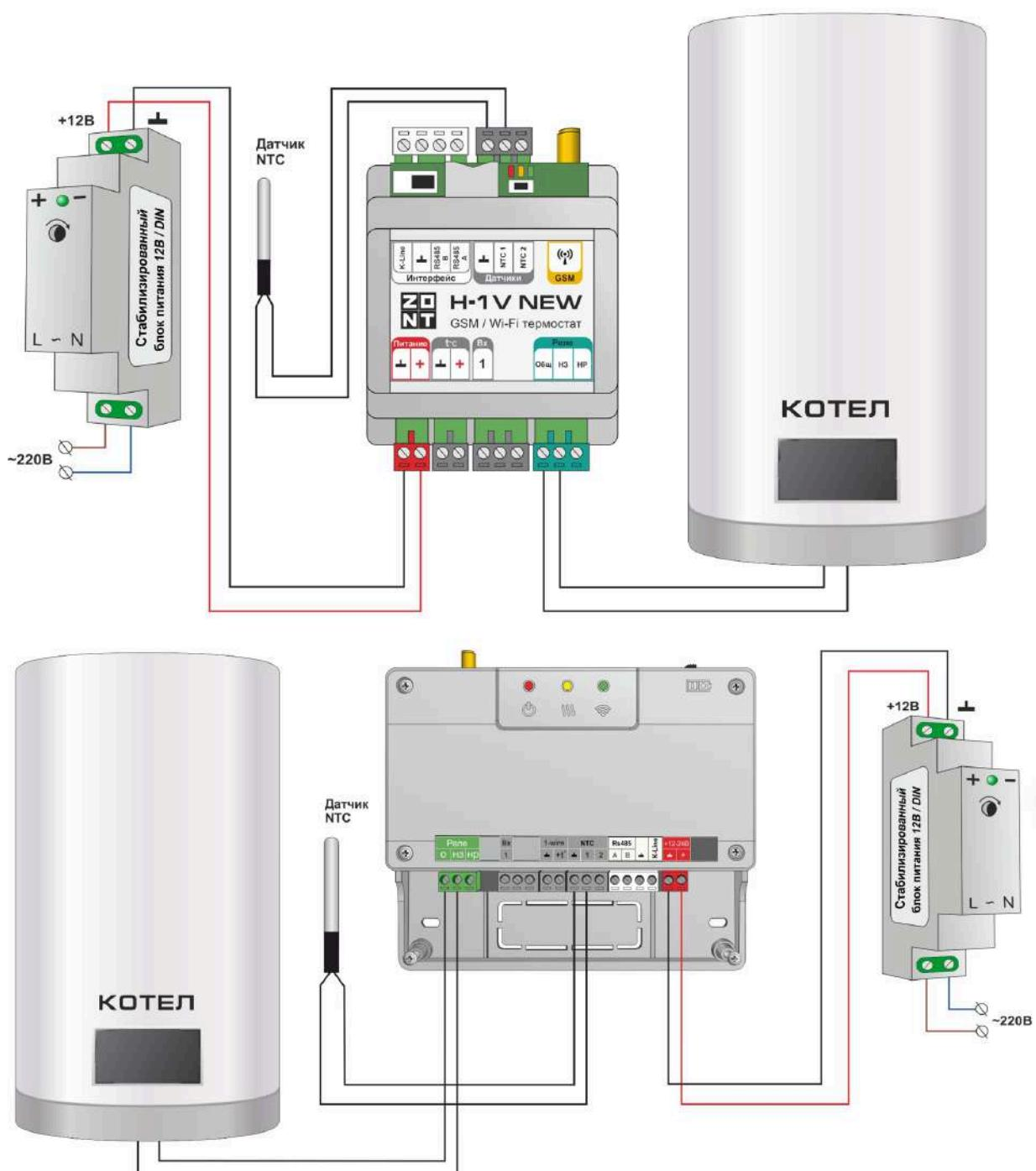
При расширении базовой комплектации дополнительным устройством адаптером цифровых шин, Термостат управляет котлом **цифровым способом**.
