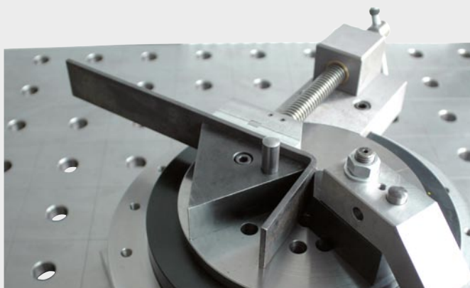
Flacheisen 40 x 4 mm abgekantet
