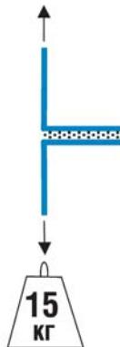
Усилие на разрыв шва должно составлять не менее 150 Н/50 мм (15 кг/50 мм).
