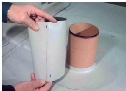
...и сваривается по отметкам в трубку, причем в нижней части диаметр трубы увеличивают, смещая край мембранны от риски на 10 мм.
