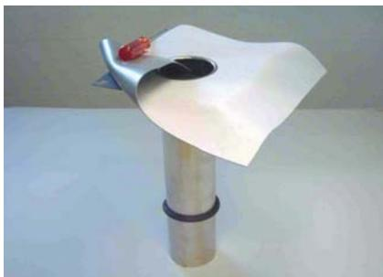
Для изоляции кровли в местах примыкания к водосточным трубам, расположенным в вертикальной плоскости, устанавливаются водоприемные воронки с фартуком из мембранны **ALKORPLAN**. Для надежной изоляции применяются герметизирующие кольца.
