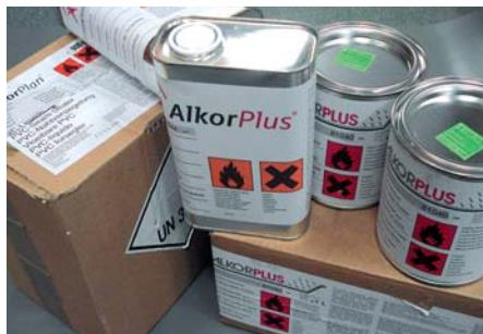
Комплектующие материалы кровельных систем **ALKORPLUS** (очиститель мембранны, контактный клей, разбавитель, краевой герметик) должны храниться при температурах от +15 до +25 °C в герметично закрытой таре с соблюдением правил хранения легковоспламеняющихся материалов.
