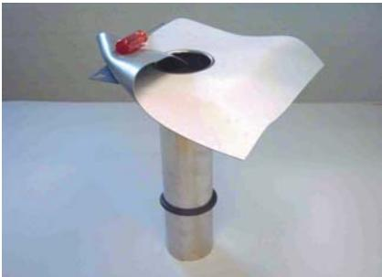
Для изоляции кровли в местах примыкания к водосточным трубам устанавливаются водоприемные воронки с фартуком из ПВХ-П мембранны **ALKORPLAN**. Для надежной изоляции применяются герметизирующие кольца.
