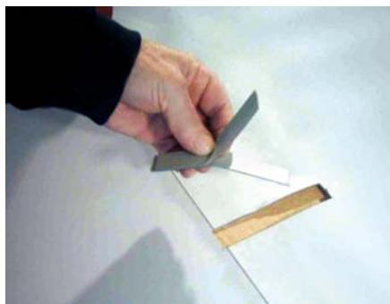
Надежность сварного шва и правильность подбора параметров сварки определяют испытанием на разрыв вырезанного участка шва шириной 50 мм путем нагружения образца весом 15 кг в течение 10 секунд.
