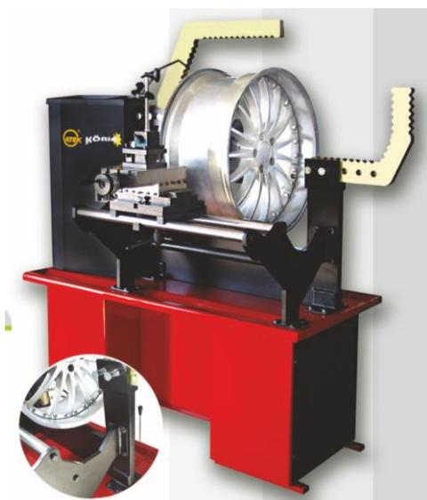
Стенд для правки литых и стальных дисков **KONIG 54 00 S**. Диаметр диска: 10-24" П-образная токарная группа. Упорная скоба. Давление 4 т./см.кв. 1 фазный (220В)/3 фазный (380В).
