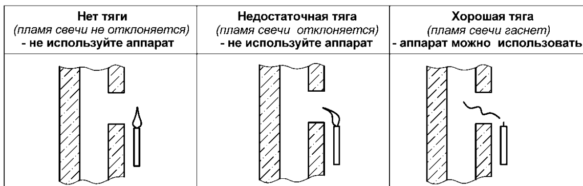
Рисунок 7. Способ проверки тяги в дымоходе
