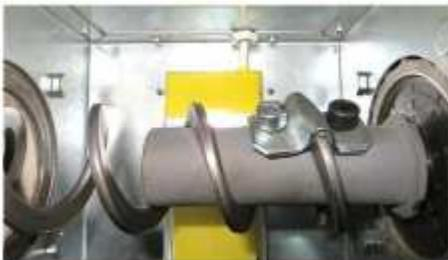
8. Когда шнек дойдет до блока управления, закрепить его на вал мотора-редуктора.
