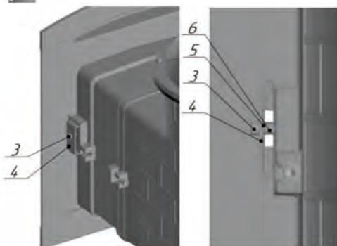
1. Прикрутить пластину поз. 4 винтом поз.3, с заранее установленными втулками
