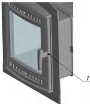
1. Прикрутить ручку винтом поз.1, с заранее установленными втулками, шайбами
