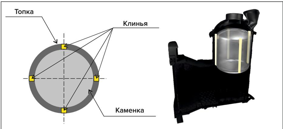
Обратите внимание: В некоторых случаях установка клиньев возможна снизу, со стороны топки, при этом нужно ослабить винты купола и заливной горловины, а разбирать дымоход и снимать купол не обязательно.
