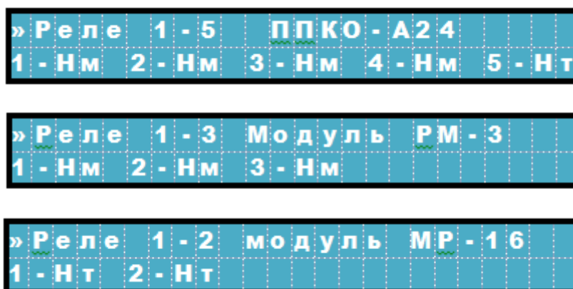
Рис. 30. Вид текущего состояния реле прибора и компонентов
