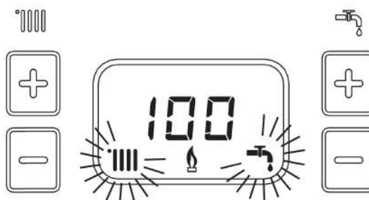
рис. 13- Режим TEST (мощность системы отопления = 100%)
